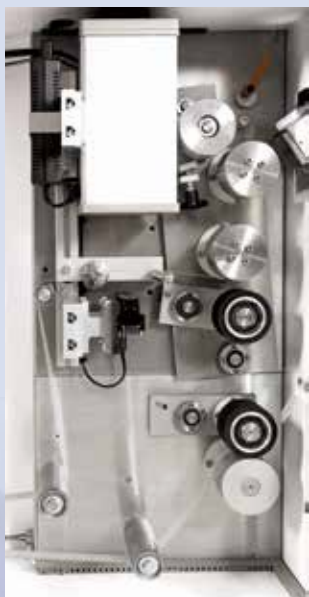
Folienabzug mit Folien-Qualitäts-Analysator
